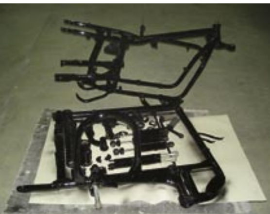
Alle Rahmenteile werden schwarz lackiert.
