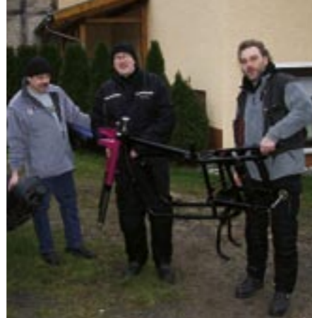
Es kann losgehen: Der Rahmen mit Hinterradschwinge und Telegabel.
